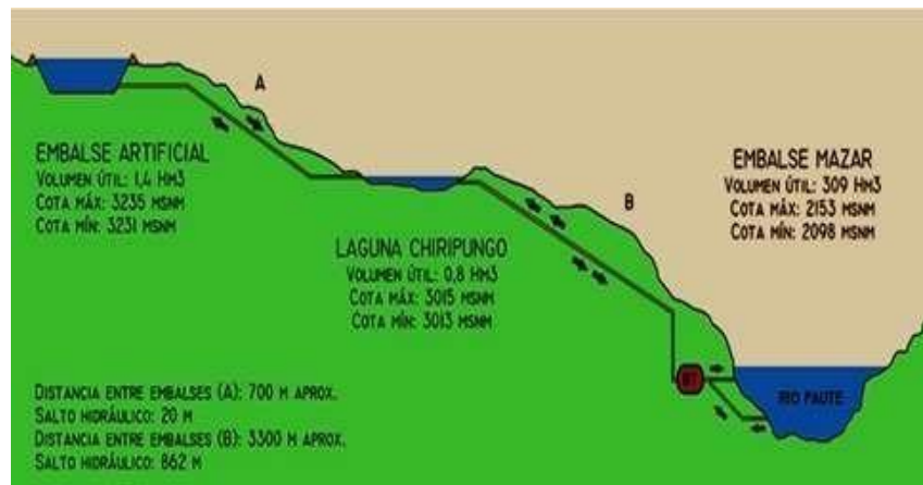
Figura 4.- Aprovechamiento de la topografía andina, laguna artificial y la laguna de Chiripungo existente en la zona, para adaptar centrales hidroeléctricas reversibles, al complejo hidroeléctrico de presas sucesivas.
