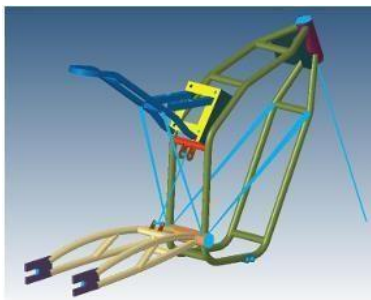
Figura 5. Refuerzos sugeridos a la estructura.
