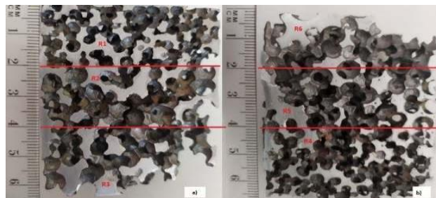
Figura 2. Probetas subdivididas en seis regiones Fuente: Rodríguez (2021)
