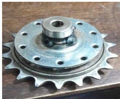
Figura 3. Sistema de acoplamiento entre el piñón y el rotor de motor generador. (Autoría propia).
