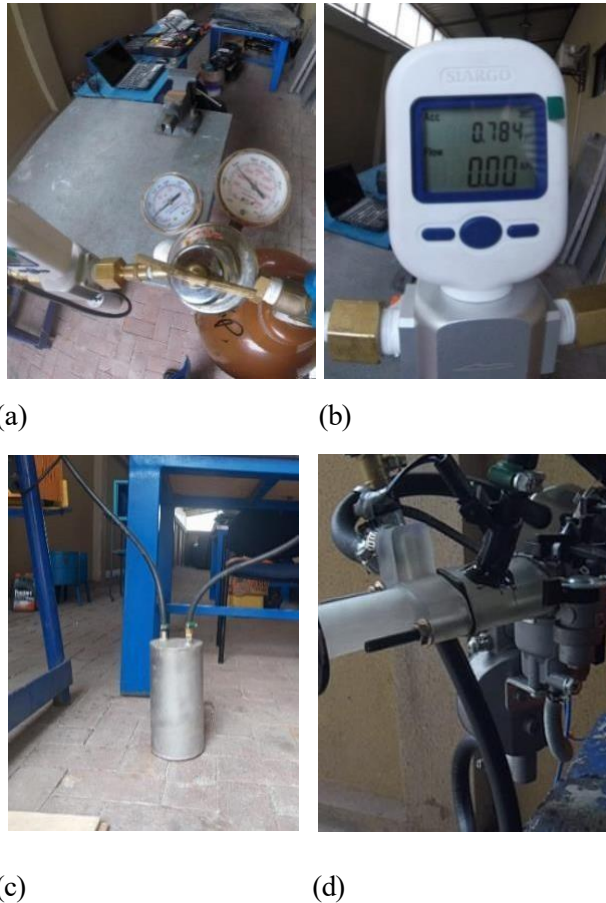
Figura 2. Sistema de alimentación de hidrógeno en un motor de encendido provocado. (a) Tanque de hidrógeno, regulador de presión y caudal, (b) Flujómetro, (c) Burbujeador y (d) Inyector
